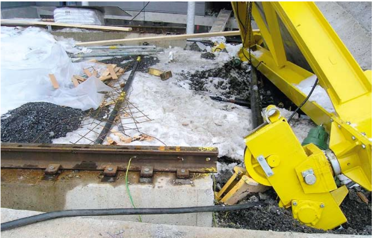
Kuva 3. Kiskolta puidonnut nosturin pyörä. Edessä olevan pyörän alla näkyy poispaikoiltaan pudonnut ns. liikevaimennin.
