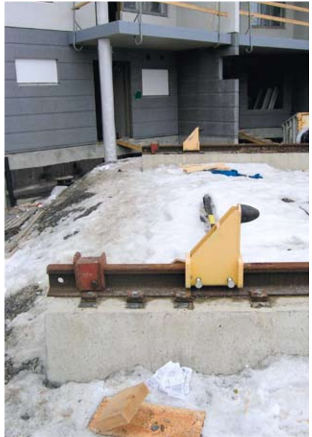
Kuva 2. Nosturiradan toisessa päässä vielä kiinni olevat liikevaimentimet ja kiinteät liike-esteet.
