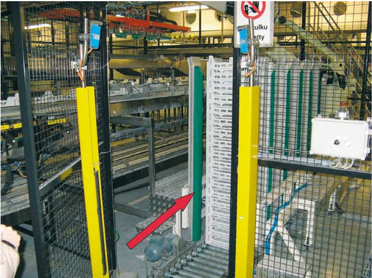
Kuva 1. Todennäköisesti NN meni robottisoluun, ts. robotin vaara-alueelle, työohjeiden vastaisesti materiaalin kulkuaukosta, ts. samasta aukosta, josta sinne ohjataan käsiteltävä materiaali.
