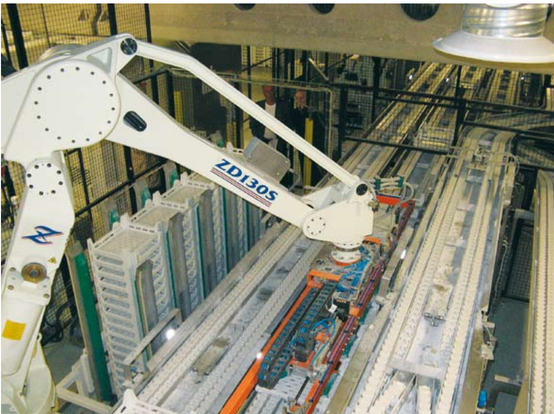
Kuva 3. Kuva tilanteesta, jossa robottitarttuja tarttuu kuljetinradalla oleviin tarjottimiin.
