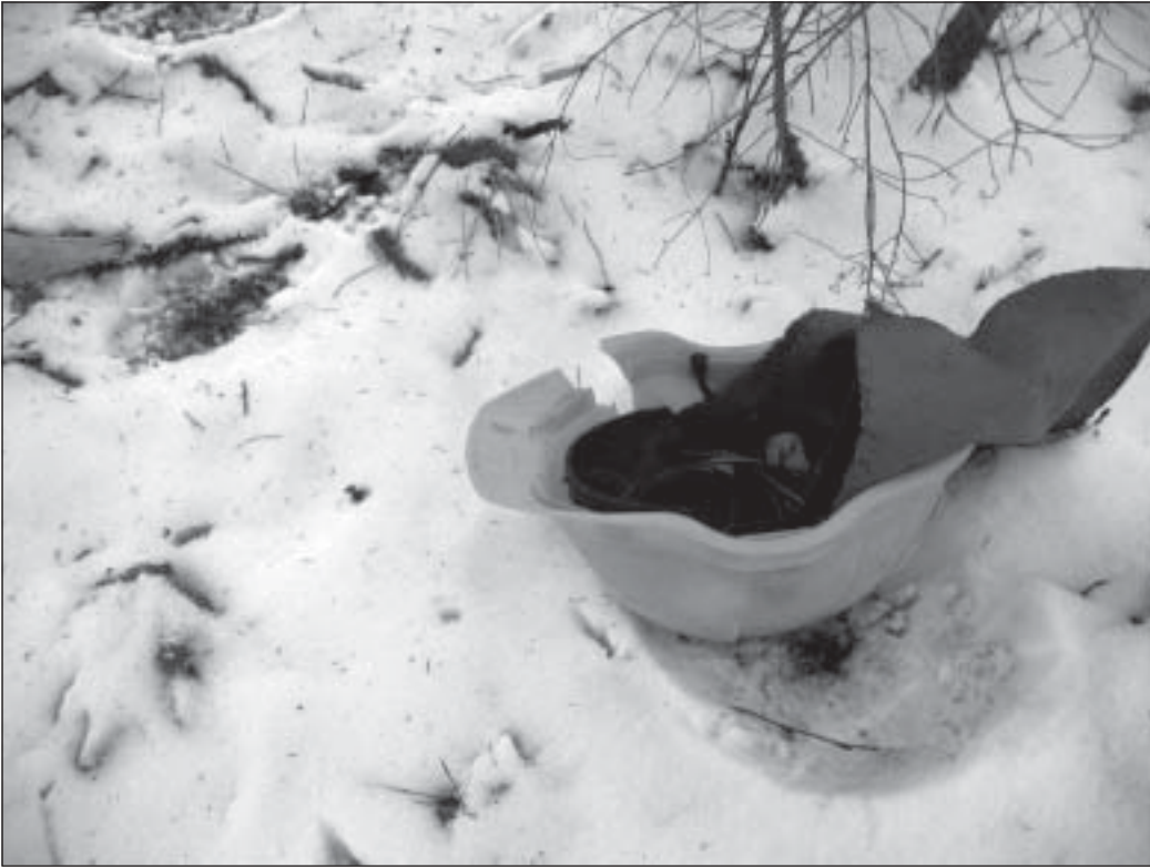
Kuva 3. NN:n päässä ollut turvakypärä, joka vaurioitui tapaturmassa.
